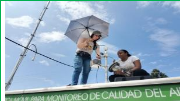
Foto 106. Ajustes BAM PM 2.5 Estación móvil de calidad de aire. Sitio: CRC Vivero La Florida. Municipio Popayán, Cauca
